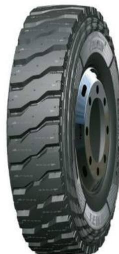
El compuesto de la banda de rodadura utiliza una innovadora fórmula de minería profesional, resistente a las piedras y a los desgarros y caídas.
